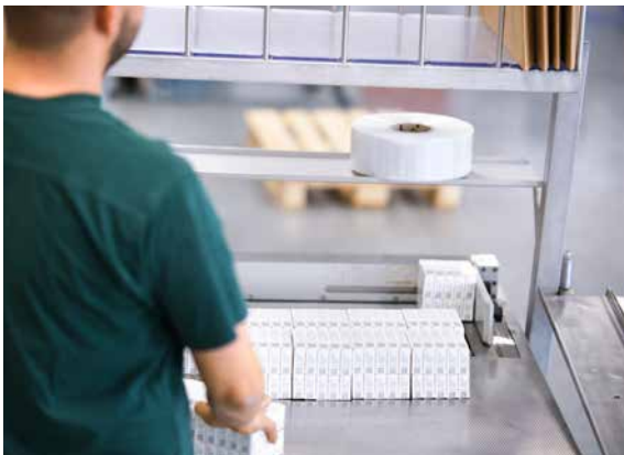
Die fertigen Packungen der Arzneimittel werden nach dem Serialisieren und Bündeln unter nochmaliger Kontrolle der Verpackungslinie entnommen.
